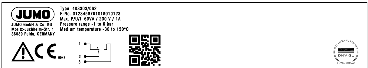
Abb. 3-4 Typenschild in Ausführung Schiffbau
