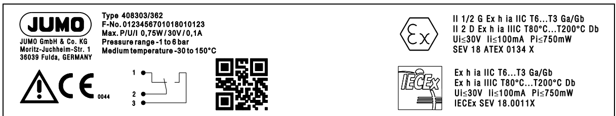
Abb. 3-2 Typenschild in Ausführung Explosionsschutz eigensicher, Ex i
